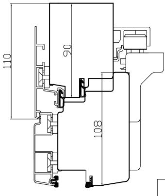
PORTATA FERRAMENTA KG 80 LARGHEZZA MAX BATTENTE: mm 900
