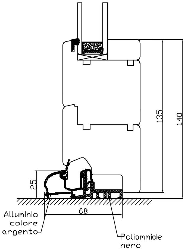
NODO INFERIORE CON TELAIO IN LEGNO RIDOTTO
